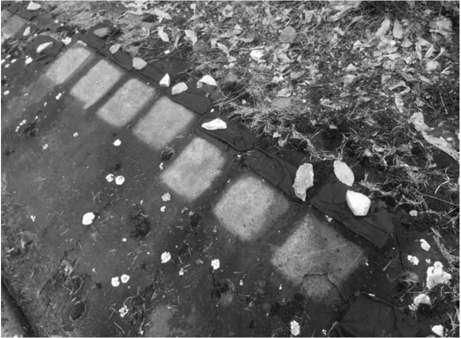
Fig. 3 - L'allestimento sulla Roccia 30 del Parco Nazionale delle Incisioni Rupestri, loc. Naquane (Capo di Ponte-BS) di tasselli di prova per monitorare l'efficacia di trattamenti contenitivi dei fenomeni di ricolonizzazione che seguono la pulitura delle superfici.
